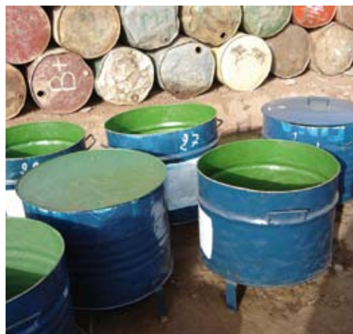
Poubelles réalisées à partir de bidons d'hydrocarbures de 200 litres.
